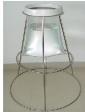
图 2 实验聚乙烯袋及其支撑系统
